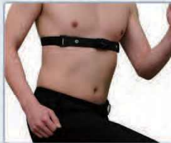
2. 가슴벨트 단독사용 방식 송신기(DSM100) + 가슴벨트(DSM100B)
