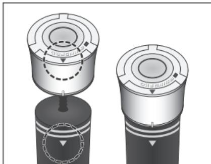
장착 방향 표시부와 그림 마크가 일치하게 그림 끝까지 밀어 넣어 장착합니다.
